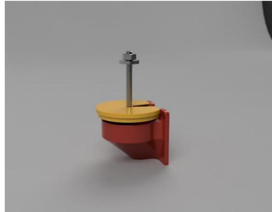
3.) In die Sitzstange muss ein Loch mit 10mm bis 11mm Durchmesser gebohrt werden. Die Hühnerstange muss nicht mit Werkzeug fest angeschraubt werden, es reicht wenn die Mutter handfest angezogen wird. Es muss noch Platz für den Deckel zwischen dem kleinen Turm und der Stange sein. Die Sitzstange darf nicht bis an die Wand reichen, hier sollten mindestens 1cm Abstand gelassen werden.
